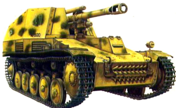
Sd.Kfz. 124 "Веспе" - 105 мм самоходная гаубица. Германия, 1943г.
